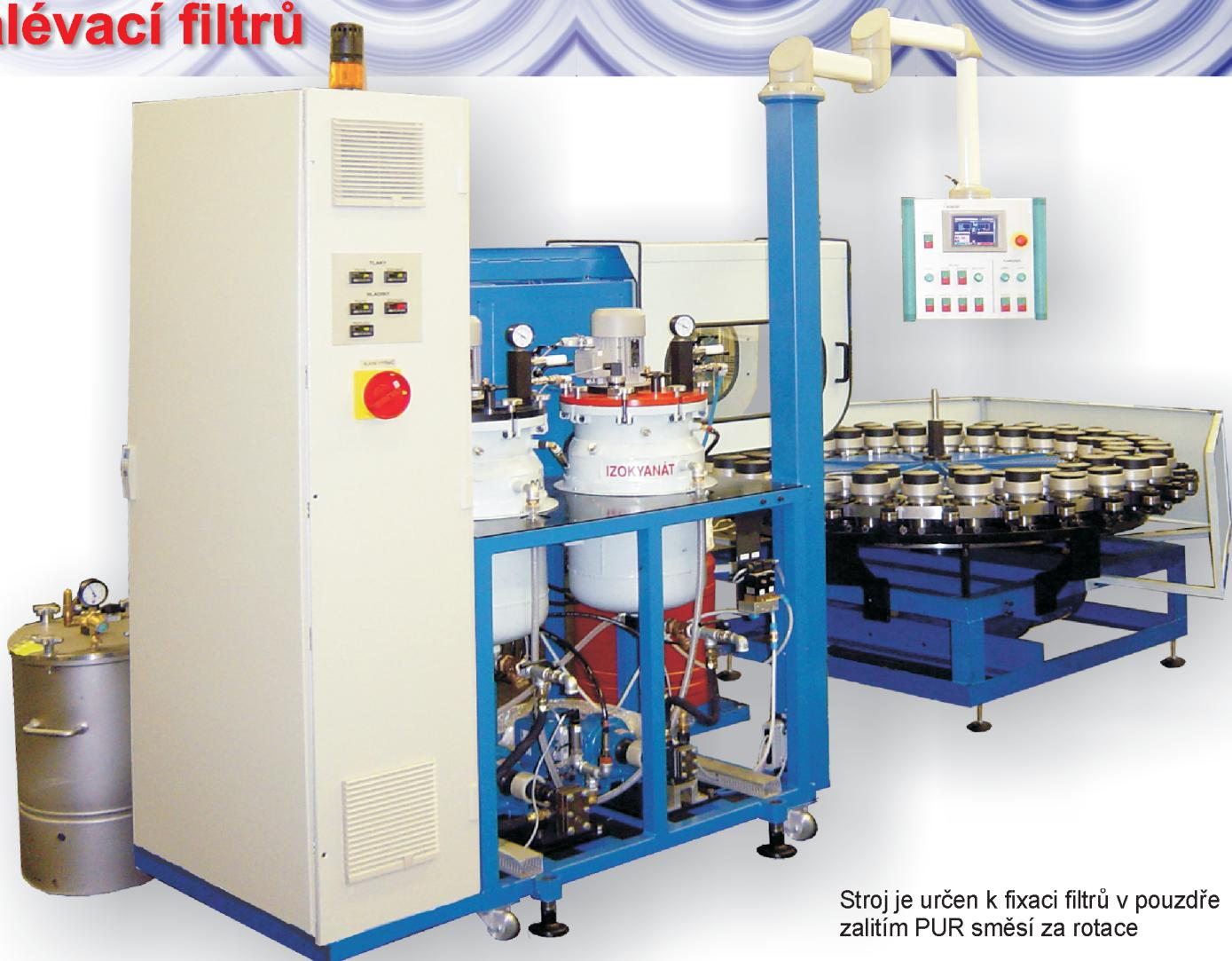
Stroj je určen k fixaci filtrů v pouzdře zalitím PUR směsi za rotace
